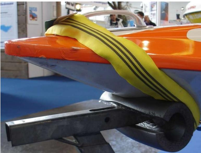
Kopfschlinge mittels Schlaufengurt
