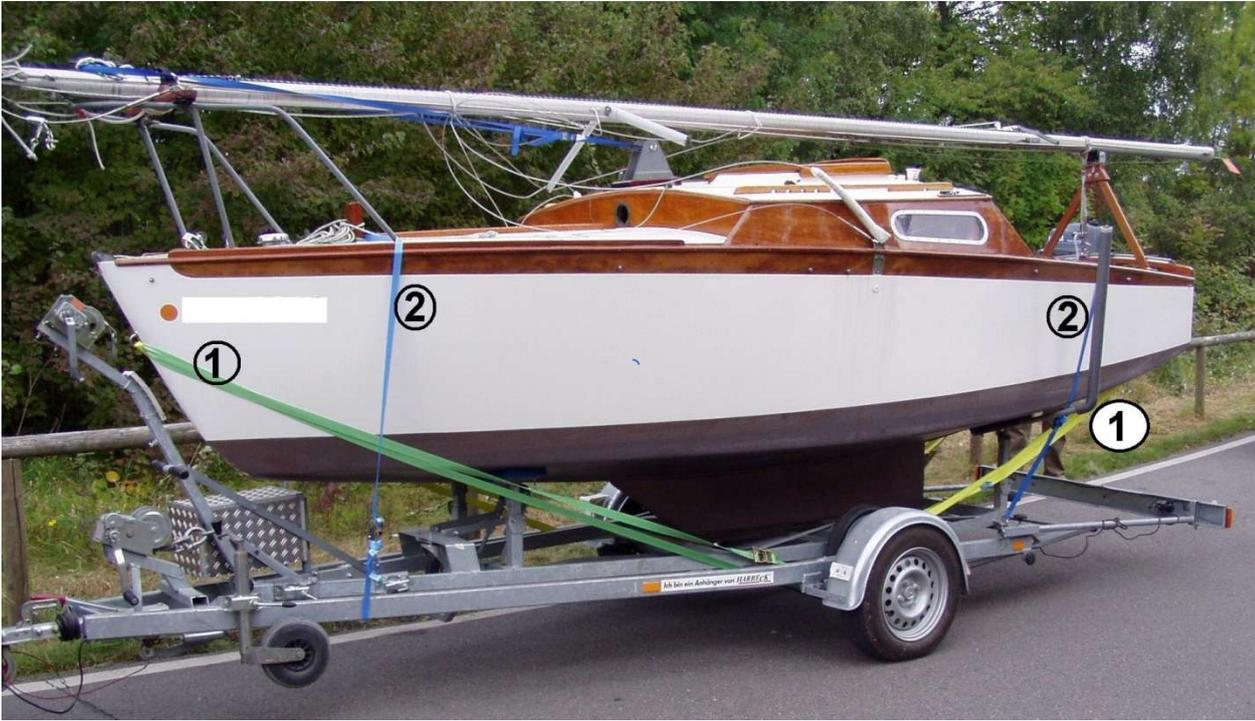
Bei dieser Ladungssicherung werden zwei Sicherungsarten kombiniert:
