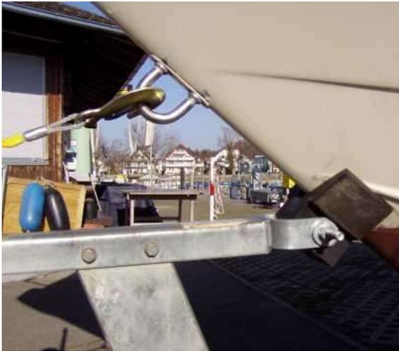
*Aufgrund der massiven Bauweise offensichtlich ein leistungsfähiger Zurpunkt/Bugöse.*
