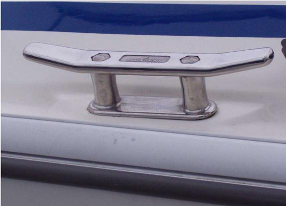
*Nicht jeder Zurpunkt/jede Klampe ist für die Ladungssicherung geeignet. Festigkeit der Bauweise und der Befestigung sorgfältig prüfen. Augenscheinlich stabiler und geeigneter Zurpunkt/Klampe.*
