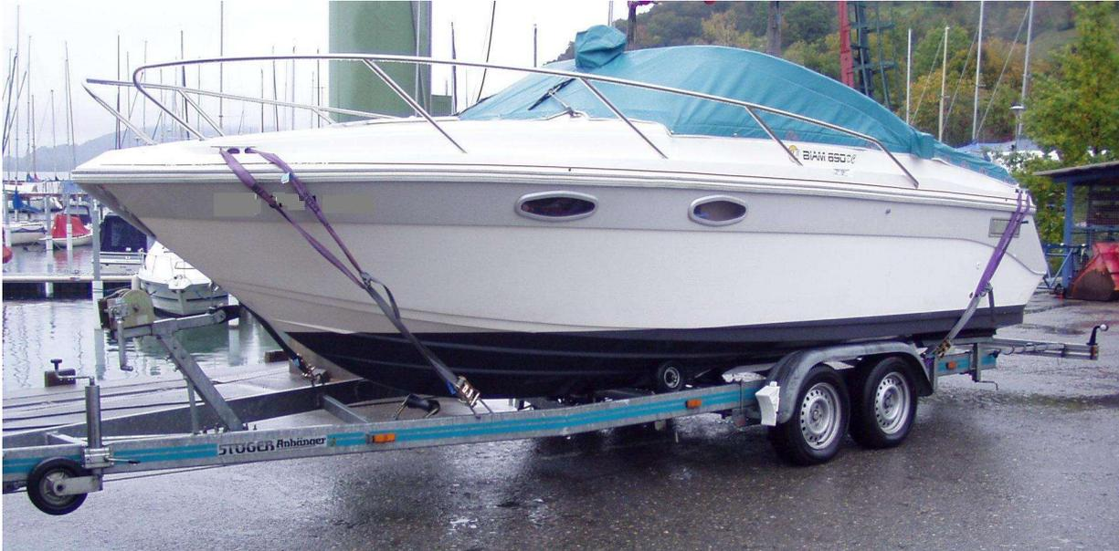
Der Vorteil dieser Ladungssicherungsart gegenüber dem Niederzurrverfahren besteht darin, dass bei größeren Massen vier Gurte ausreichen um die Sicherungskräfte aufzunehmen.
